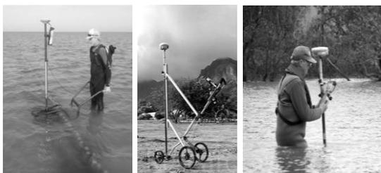
**Gambar 7.** Survei zona intertidal dengan RTK GPS
